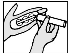
Coltène® Lab-Putty Base se dosifica con la medida (elimine el exceso). Extienda sobre la palma de la mano la cantidad dosificada. Por cada medida de material usado imprimir un contorno de medida. Por diámetro de la circunferencia
