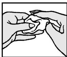
Material falten und mit den Fingerspitzen 30–45 s kneten, bis eine homogene, rosafarbene Mischung entsteht.
