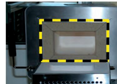
Abb. 4: Klemmbereich Klapp-Ofentür
