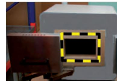
Abb. 5: Klemmbereich Schwenk-Ofentür
