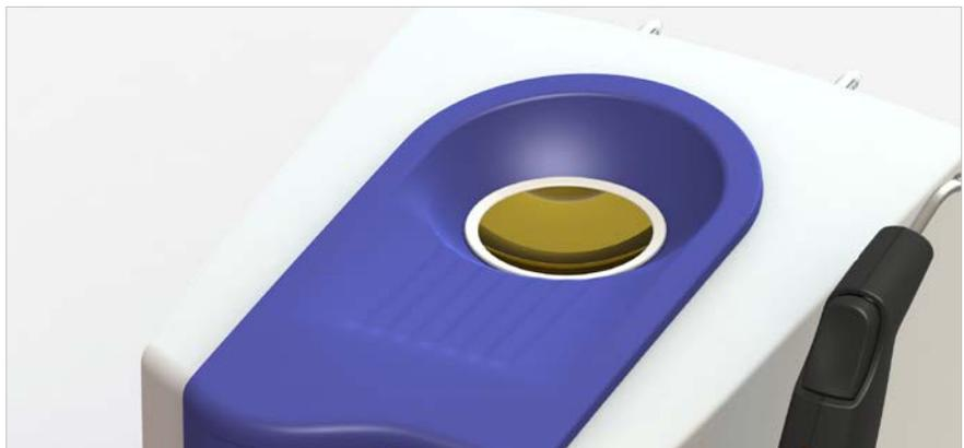
Abb. 5.2.2. Sieb zum Befüllvorgang in die Auffangwanne eingelegt
