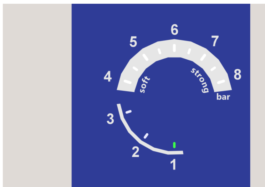
Bild 7.4.5.2: Manometer Anzeige Entkalkungsschritte 1-8
