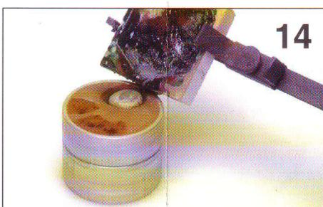
14. Wenn Sie das Metal geschmolzen haben können Sie bei eingießen das Schmelztiegel auf dem Rand liegen lassen. Das macht es einfacher eingossen.
