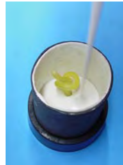
NoWax kann direkt eingebettet und ausgebrannt werden.
