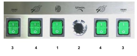
Schalter 1 Wippschalter Ein/Aus für Poliermotor
