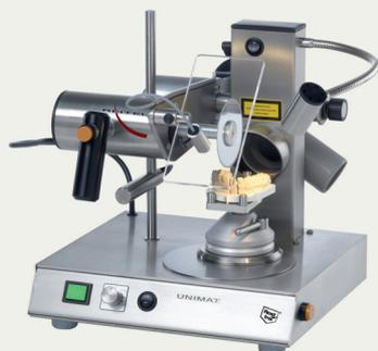
Zahntechnische Modelle lassen sich mit der Modellsäge UNIMAT mit größter Präzision trennen und sägen. Die einstellbare Axialverstellung des Sägeblattes ermöglicht zehntel-millimetergenaue Justierung. Mit dem diamantbestückten und drehzahlgesteuerten Trennblatt können dünnste Schnitte durchgeführt werden. Die Schnittführung lässt sich mit dem optionalen Laser noch besser ermitteln. Die Halogenleuchte hellt den Arbeitsbereich auf und ermöglicht eine angenehme Tätigkeit.
