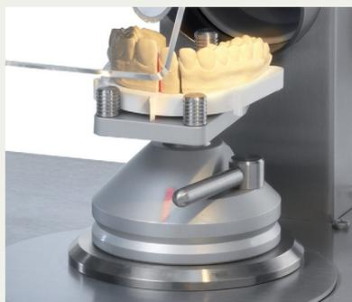
Mit dem Modelltisch fixieren Sie Modelle vieler am Markt befindlicher Systeme. Der schwenkbare Tisch ermöglicht eine genaue Führung und die Schnitte werden exakt ausgeführt. Der Tisch wird magnetisch auf der Aufnahme gehalten, sobald die richtige Position gewählt wurde.
