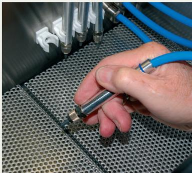
Die SANDURET Sandstrahlgeräte bieten ein optimales Abstrahlergebnis mit allen handelsüblichen Strahlmitteln von 25 bis 250 my. Die Anwendungen sind Reinigen, Mattieren, Glänzen und Oxydbeseitigung.
