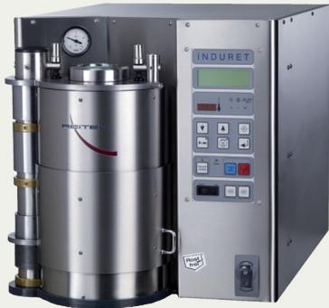
Das vollautomatische Induktionsgießgerät INDURET GENIUS garantiert Ihnen optimale, sichere Gussresultate aller zahn-technischen Arbeiten aus Edelmetall (EM) im Graphittiegel, Nichteidmetall (NEM) im Keramiktiegel sowie diversen Legierungen. Auch Modellgussarbeiten lassen sich problemlos durchführen. Das Metallgefüge der Gussobjekte ist homogen, lunkerfrei und ohne Schlackeeinschlüsse. So entstehen Gießresultate mit äußerster Konturenpräzision.
