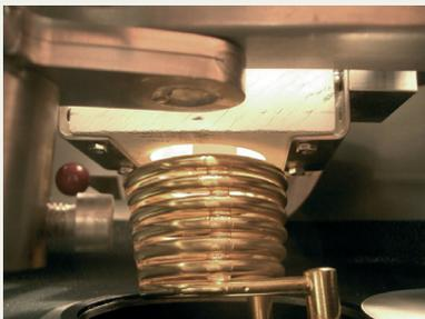
Die kompakte Tisch-Induktionsschleuder RETOCAST I eignet sich zum Vergießen aller zahntechnischen Arbeiten aus Edelmetall (EM) und Nichtedelmetalllegierungen (NEM) sowie Modelguss. Der leistungsstarke Schmelzgenerator ermöglicht durch seine Regulierung eine optimale Einstellung für Ihre Metalle und eine schnelle Gussfolge. Die einfache Handhabung, das übersichtliche Bedienfeld und das große Sichtfenster ermöglichen ein Optimum an Arbeitskomfort.
